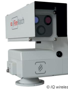
Ein Sensor liefert während einer Umlaufzeit von 4 bis 8 Minuten die Bilder für ein 360°-Panorama. Die spezielle Rauchererkennungssoftware meldet automatisch Brände ab einer Größe von etwa 10 x 10 m in bis zu 20 km Entfernung.
